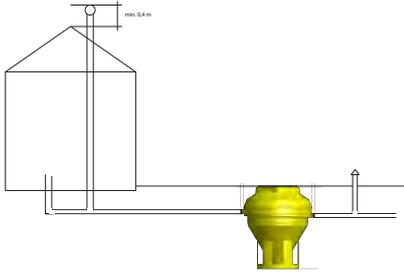
Le Conder Clereflo n'a pas de compartiment anaérobie. Du coup, la formation de méthane est minimal et que la formation de sulfite d'hydrogène était si faible qu'il n'y avait aucun risque d'explosion ou bien de danger pour la santé.
